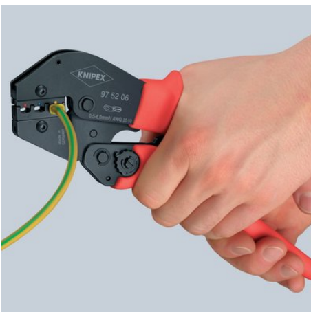
Kolmas askel: mikäli tarvitaan suurempaa voimankäyttöä esim. esitetyissä liittimissä 6,00 mm 2 , kahdenkäden käyttö on mahdollista pitempien kahvojen ansiosta
